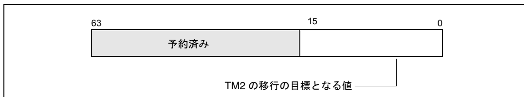
図 13-8. TM2 をサポートするインテル® Pentium® 4 プロセッサの MSR_THERM2_CTL レジスタ
