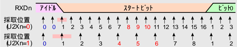
図 18-5. スタートビットの採取
