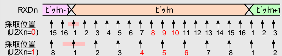
図 18-6. データビットとパリティビットの採取
