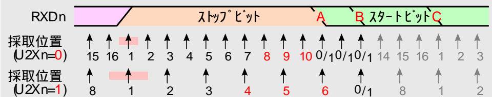
図 18-7. ストップビットの採取と次のスタートビットの採取
