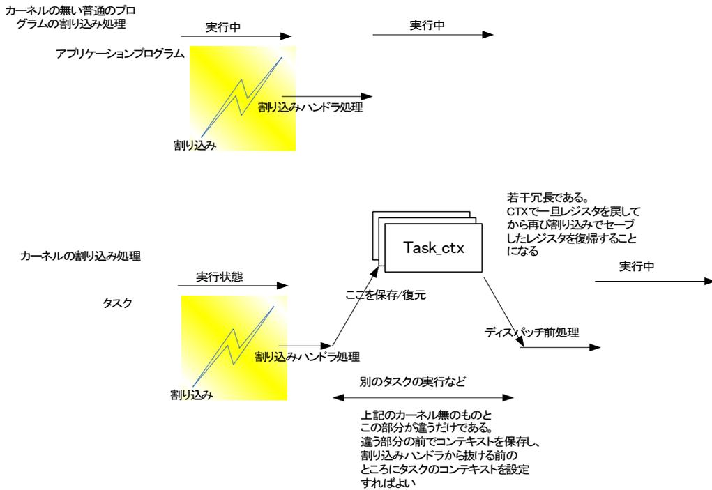
考え方は、割りこまれたら割りこまれた状態に戻って、割り込みハンドラから戻ればよい。あくまで、割り込みによって今まで実行中だったタスクが、元に戻るときに全レジスタを保存復元して戻ればよいのです。つまり、一旦、割り込みハンドラの出口にコンテキストを保存します。そうすることで、ディスパッチされると割り込みハンドラの出口に来ます。再び割り込みハンドラが保存していたレジスタを全復帰して割り込み前に戻る仕組みです。
